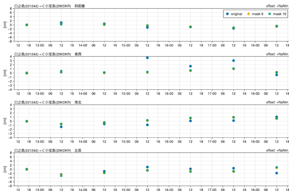
図-12 「C 小宝島」の日々の PPP スタティック解の時間変化. 電子基準点「口之島」の PPP スタティック解に対する斜距離及び座標差 3 成分. 上から斜距離, 東西成分, 南北成分, 比高. 青がマスク処理無し, 黄色が試作版の仰角マスクを適用した場合, 緑が最終版の仰角マスクを適用した場合.
