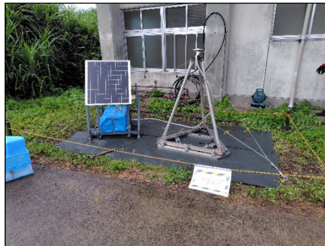
写真-2 小型 GNSS 観測点「C 小宝島」。写真は南側からの撮影であり、背後の北東側の建物によって上空視界が制限される環境である。
