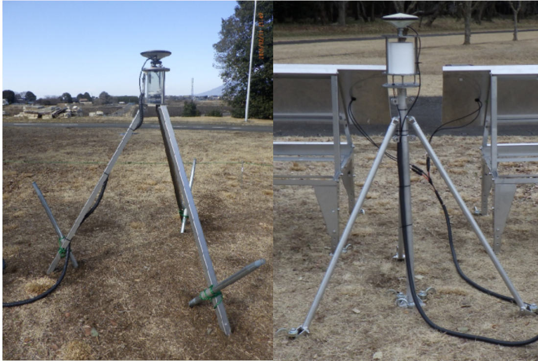
写真-2 左図は令和 6 年度に開発した観測架台。右図は令和 7 年度に開発した観測架台。
