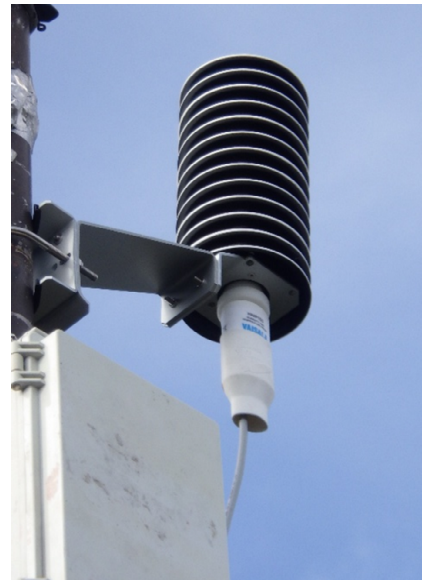
写真-2 気象ポール最上部に、VAISALA(株)製湿度温度計 HMP155 を設置。
