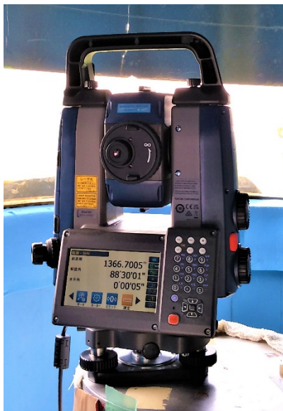
写真-1 トプコン(株)製トータルステーション iX-605 を局舎ピラー上に設置。
