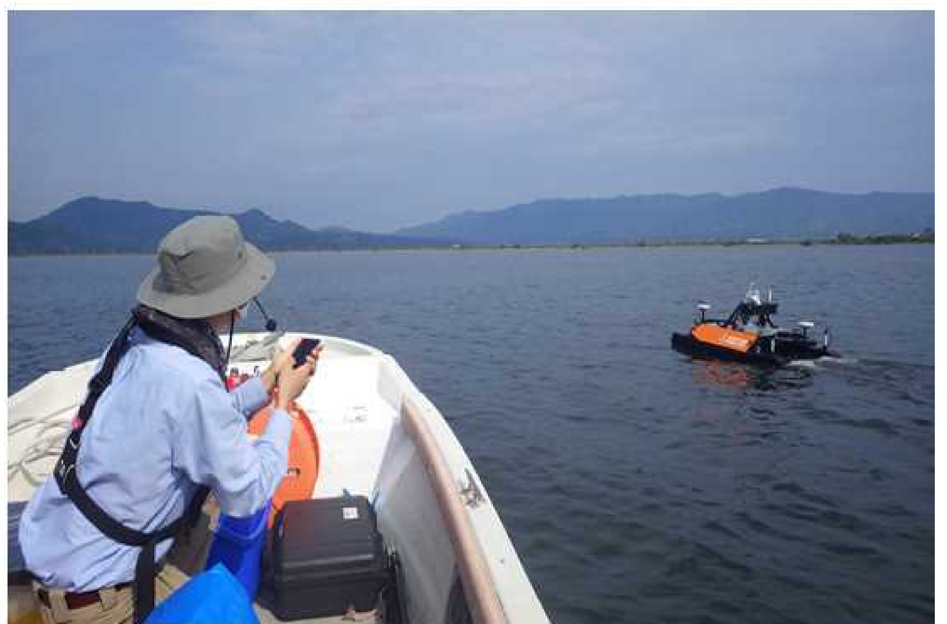
有人船並走によるUSV操作イメージ （中海での調査）
