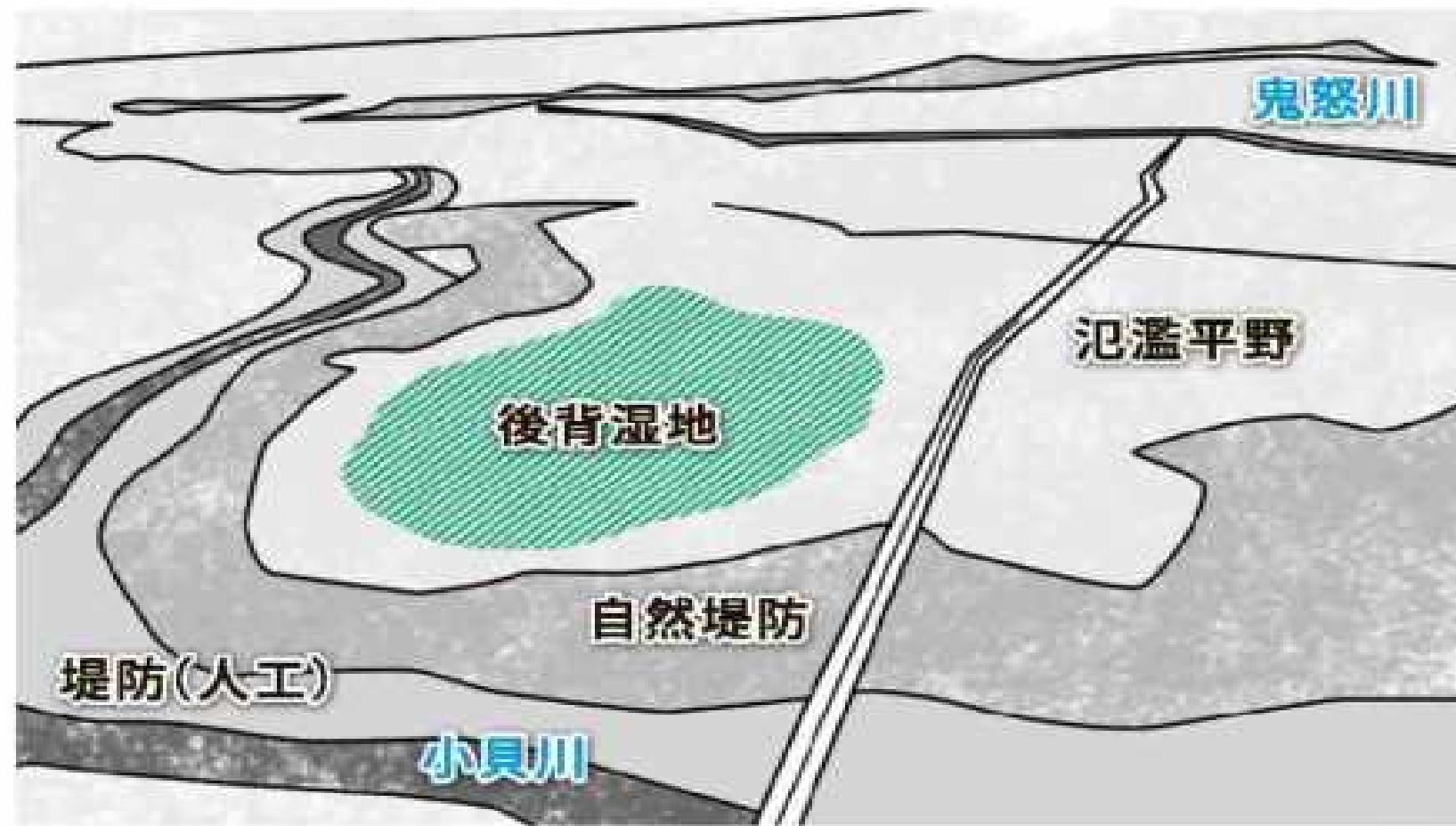
図1-16 写真1-13の模式図 周囲を自然堤防に囲まれているため、水がたまり続けています。
