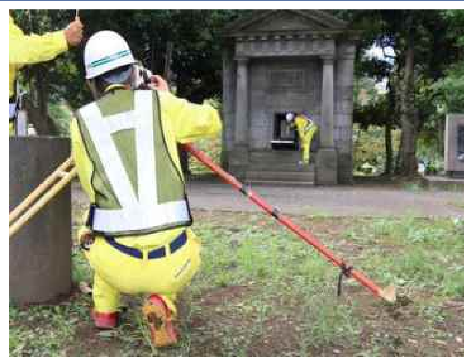
日本水準原点での水準測量
