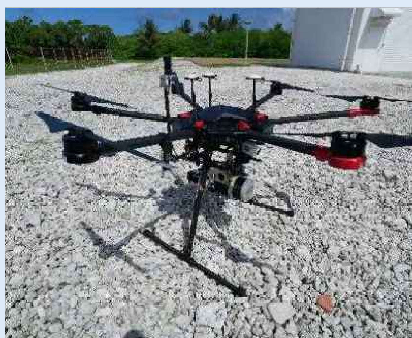
回転翼UAVによる レーザ測量
