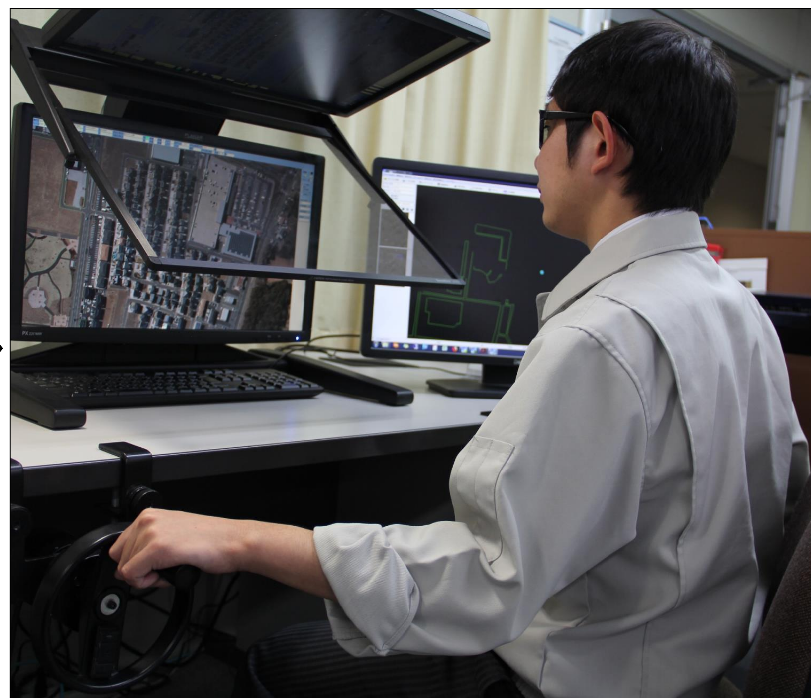
2枚の空中写真から図化機で立体視して、登山道を描く
