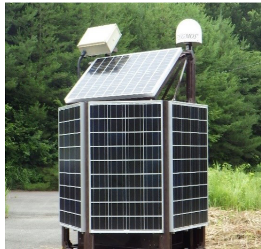
可搬型GNSS連続観測装置(REGMOS)
