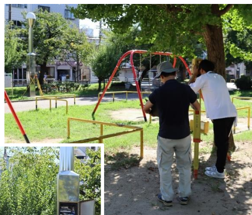
電子基準点「大阪A」の 高低差測定作業
