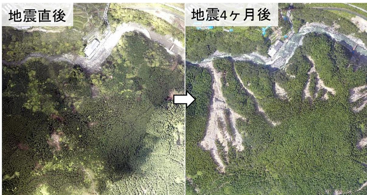
2016年熊本地震後に発生した斜面崩壊の例 (熊本県阿蘇地域)
