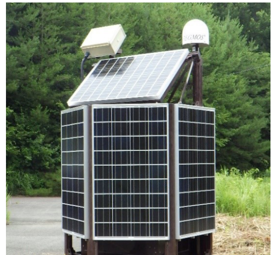
可搬型 GNSS 連続観測装置 (REGMOS)
