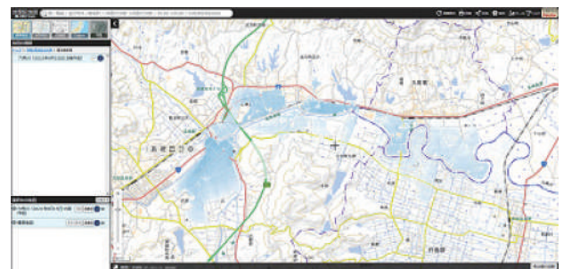
図-16 浸水推定図の表示例（六角川）
