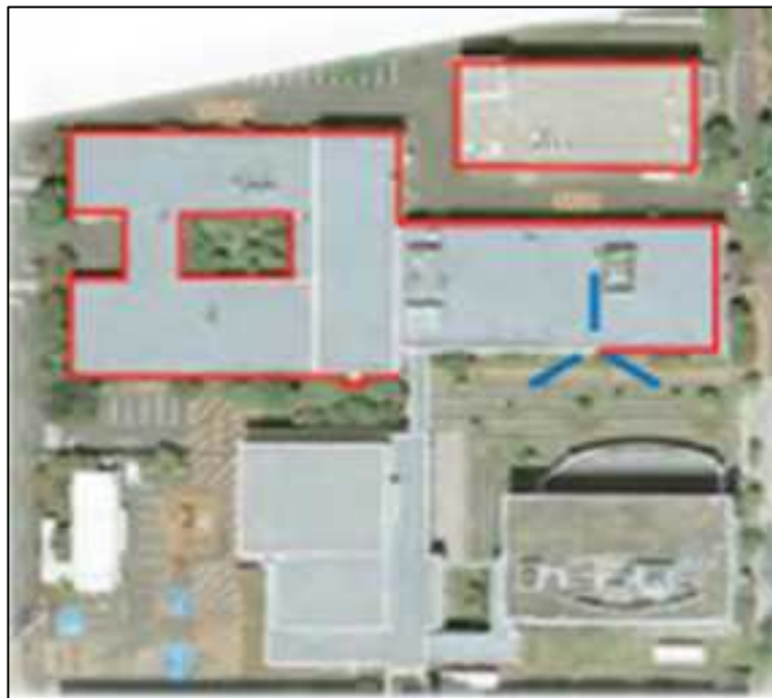
デジタルステレオ図化機でも図化素図の内容は同じ。ただし、2500レベルの図化のため、建物形状はより詳細に図化されるようになっている。
