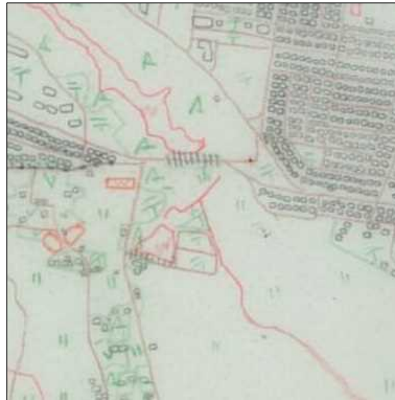
アナログ図化機時代の図化素図。土地利用なども図化機で記号が描画されている。25000レベルの図化素図のため建物の形状は簡略化して図化されている。(国土地理院HPから)
