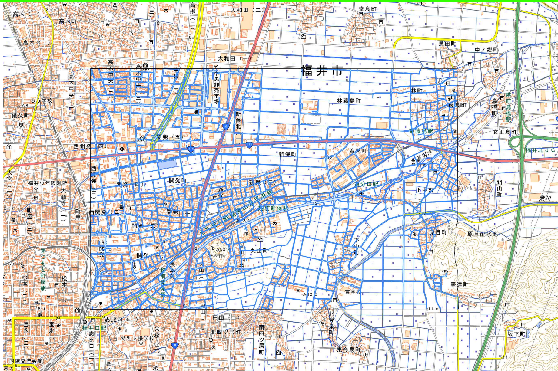
1枚の空中写真(CCB-2021-3-N-C05_0008)の範囲を地理院地図上で表示したもの。黒枠が写真の範囲。水色の線が道路の自動図化結果。人間が介在せず得られた図化結果である。
