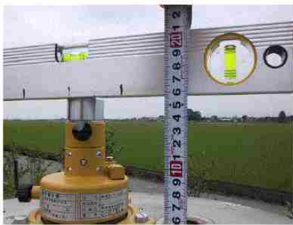
アンテナ底面高の測定例
