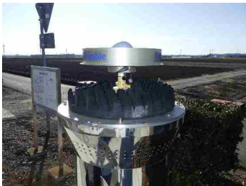
チョークリングアンテナの設置状況
