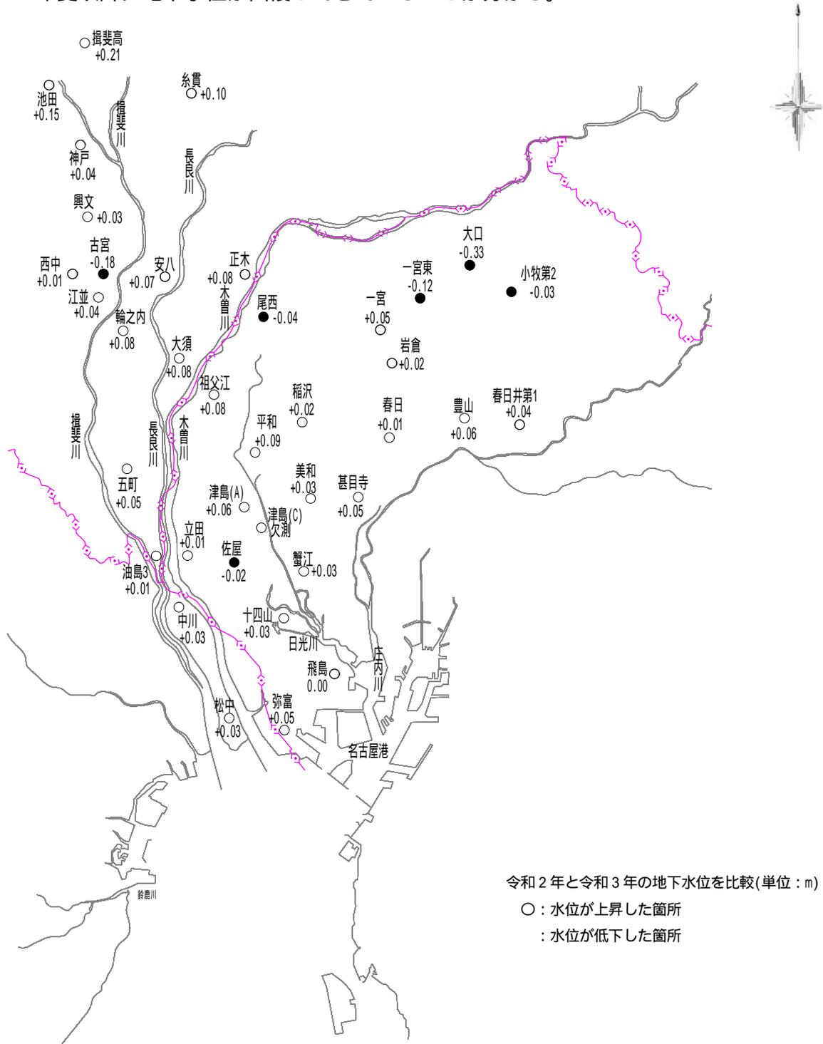
図 - 11(1) 年平均地下水位の変動量[第一礫層(G1)]
