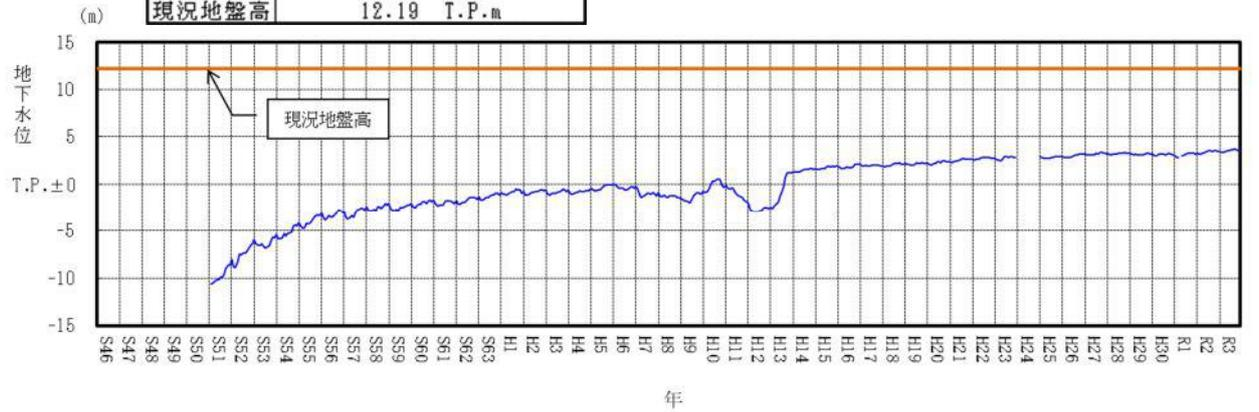
付図 - 2(8) 地下水位変動 (安井)
