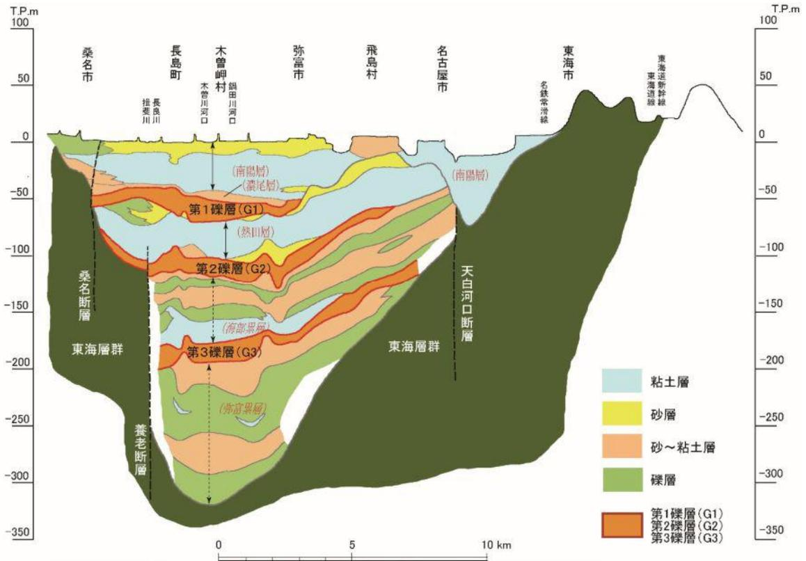
図 - 4(2) 濃尾平野の地質断面図(A - A' 測線：桑原(1985)を一部改変)
