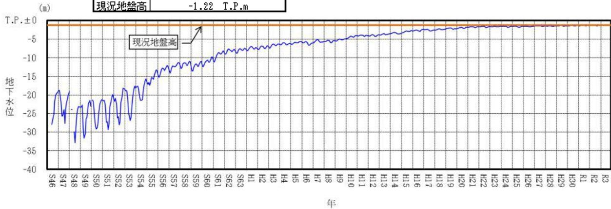
付図 - 2(1) 地下水位変動 (松中)
