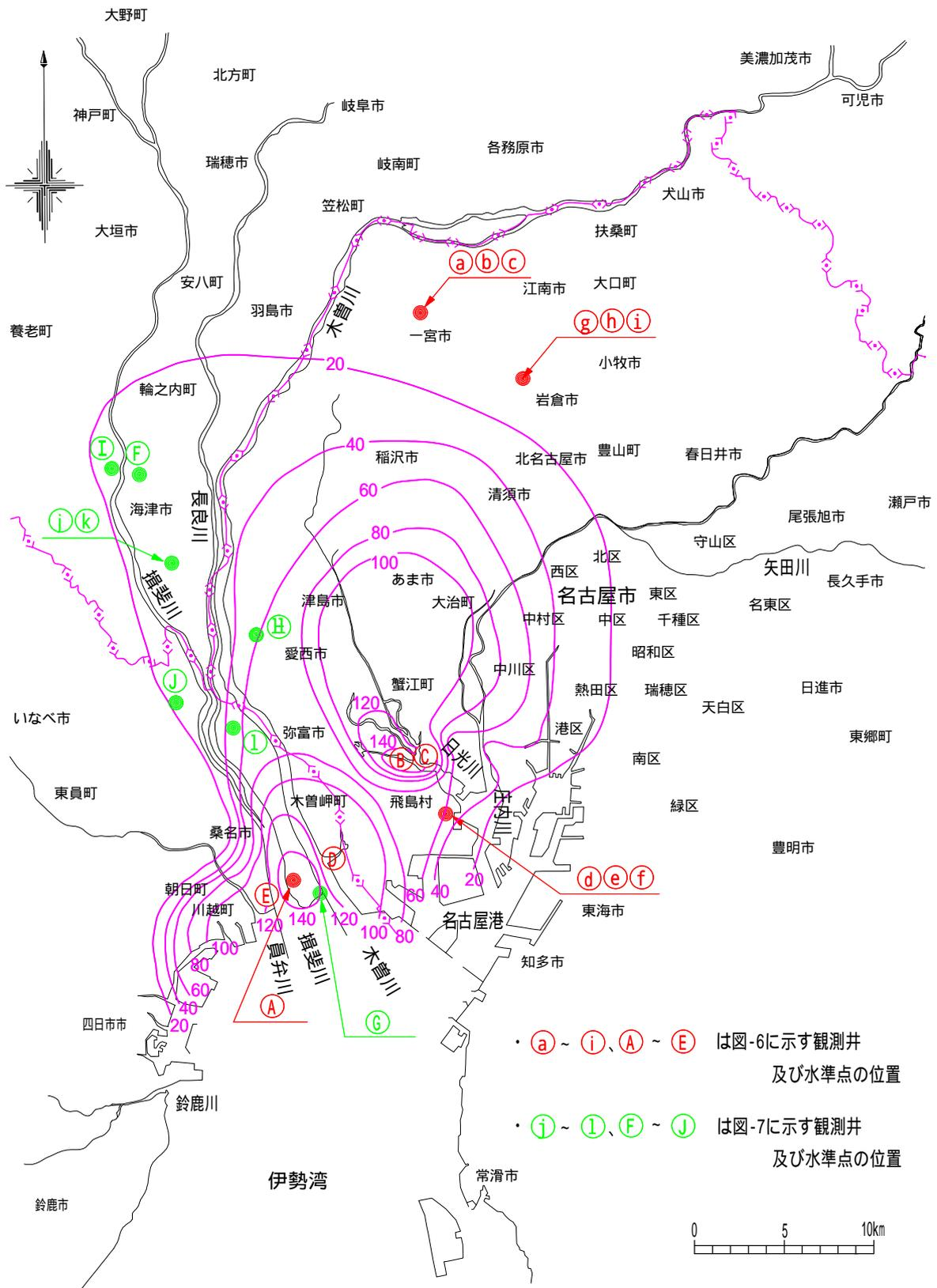
図 - 5 昭和36年以降の累積沈下量等量線(単位 : cm)
