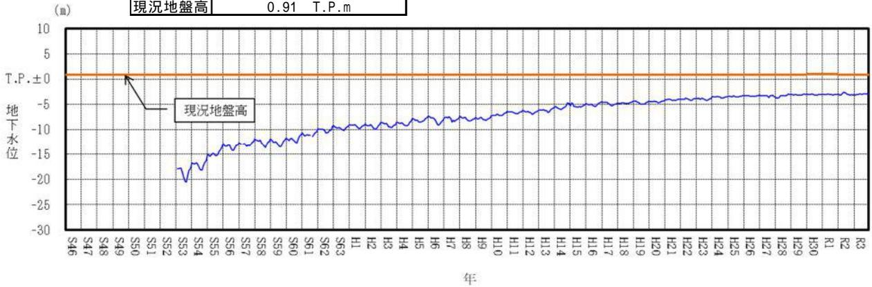
付図 - 2(18) 地下水位変動 (熱田)
