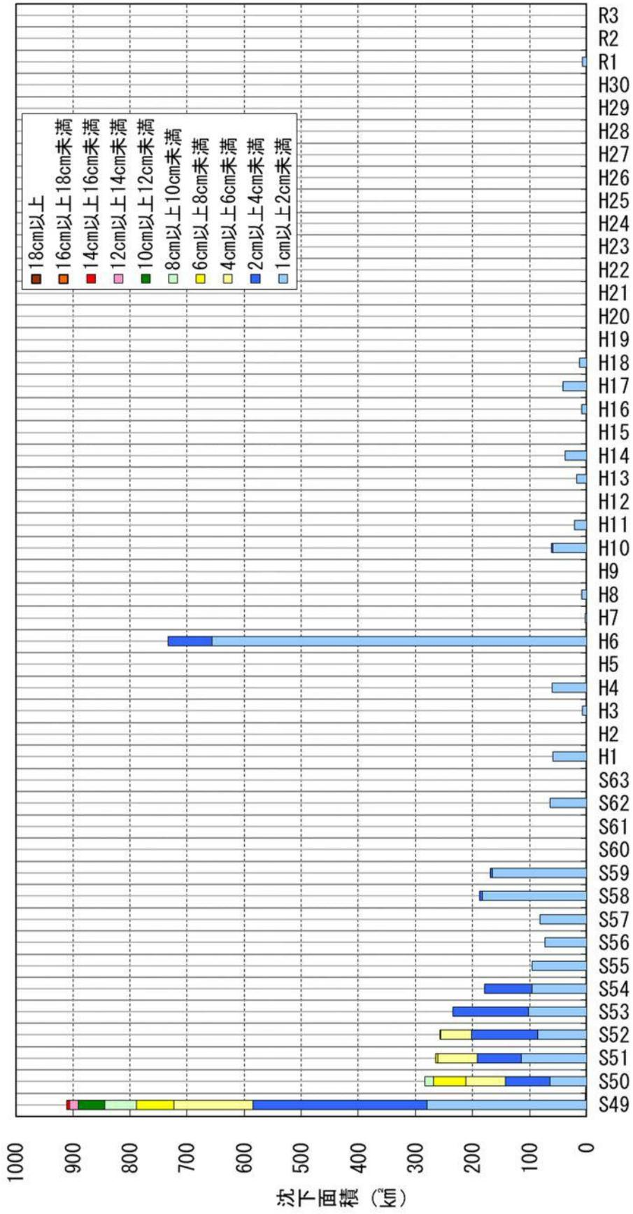
図 - 2 年間 1cm 以上の沈下面積
