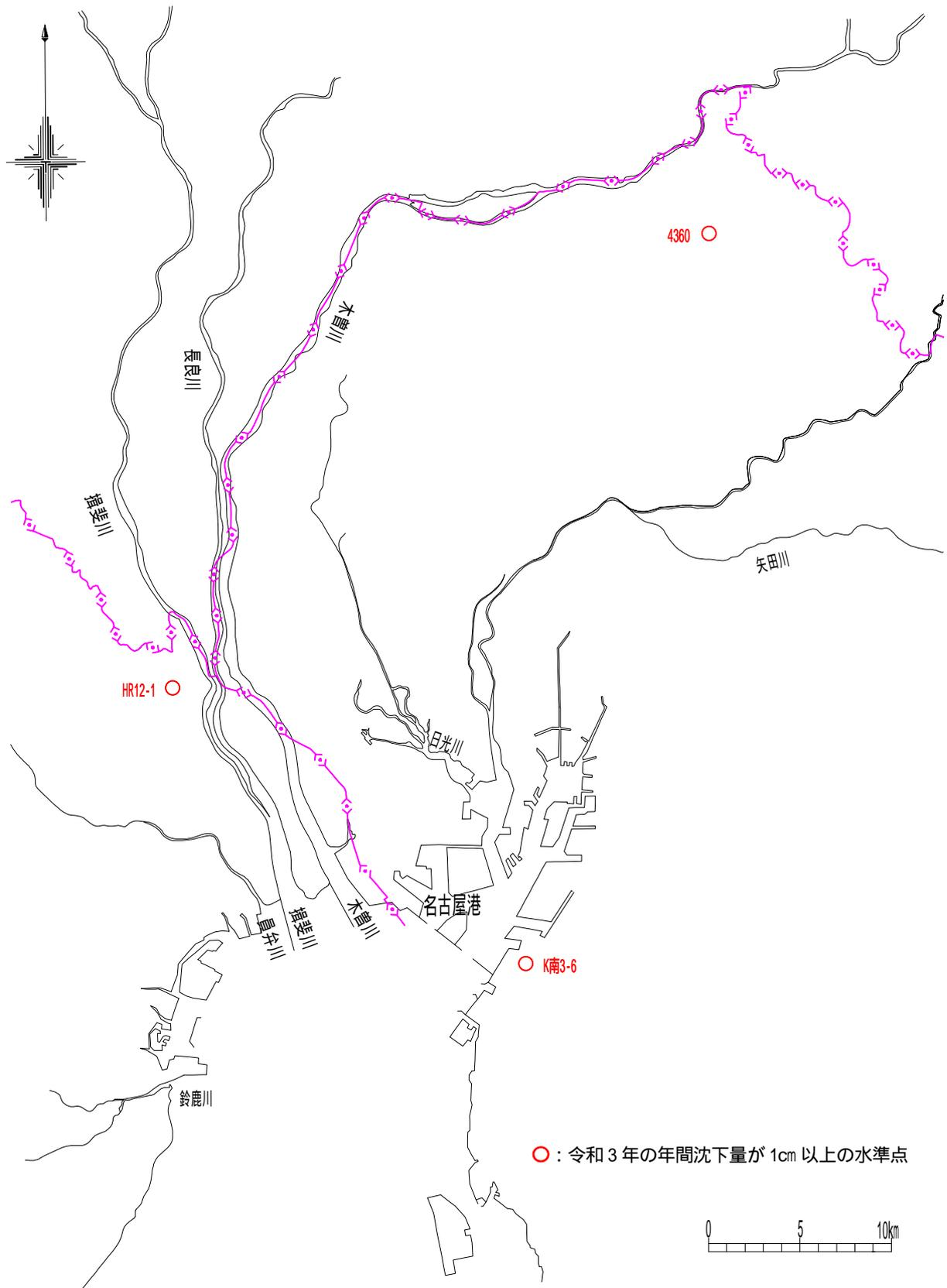
図 - 1(1) 令和3年における年間沈下量1cm以上の水準点位置
