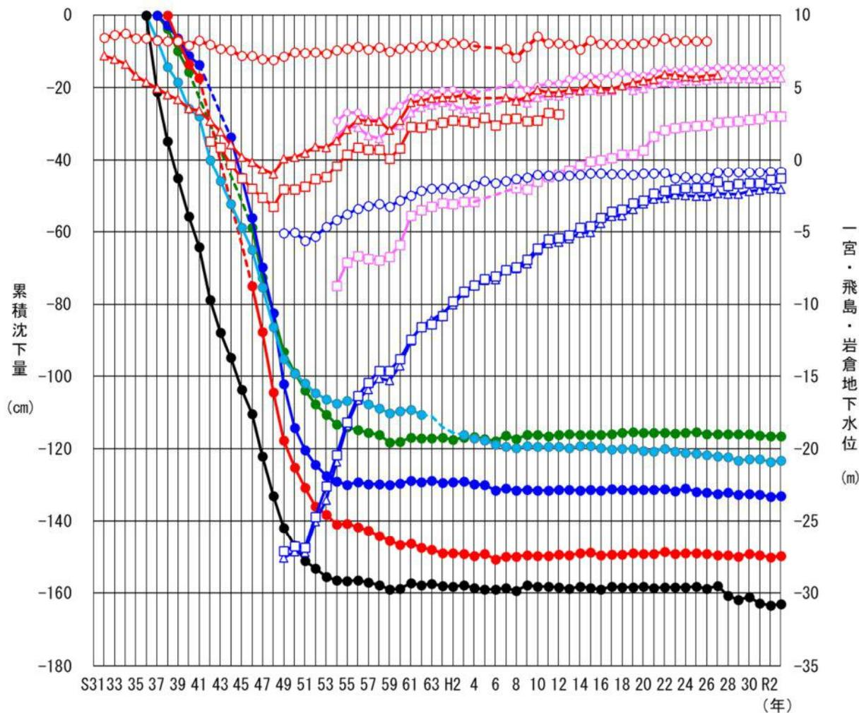
図 - 6 累積沈下量が1m以上を示す主な水準点の累積沈下量と
