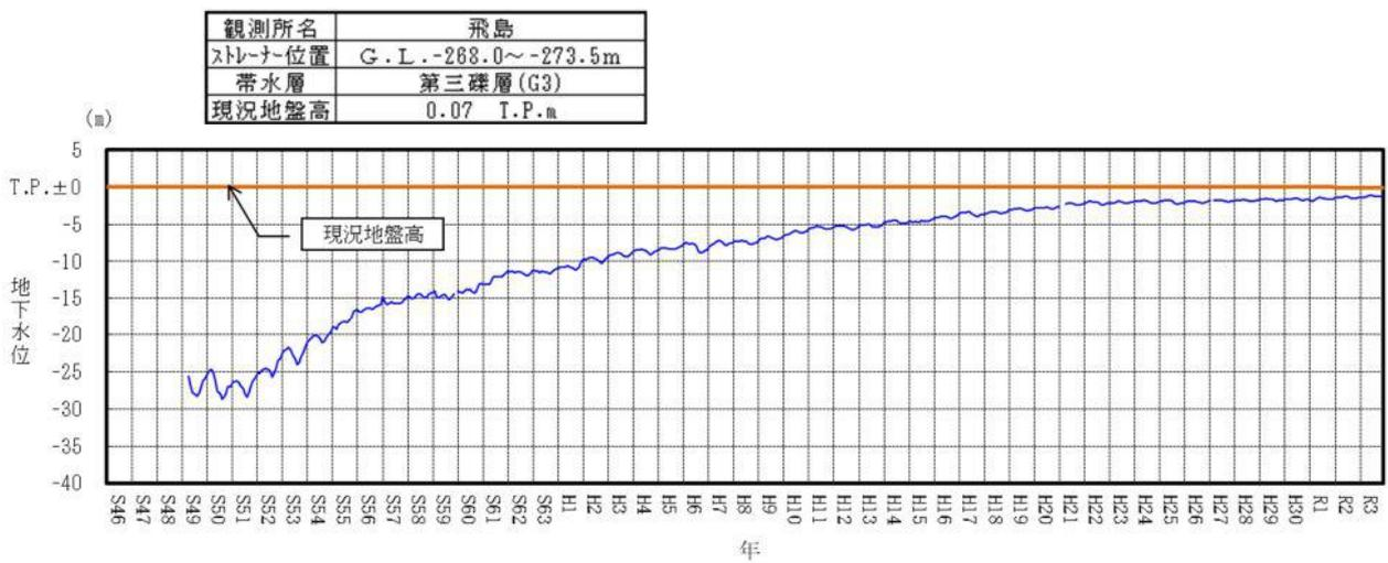
付図 - 2(3) 地下水位変動 (飛島)
