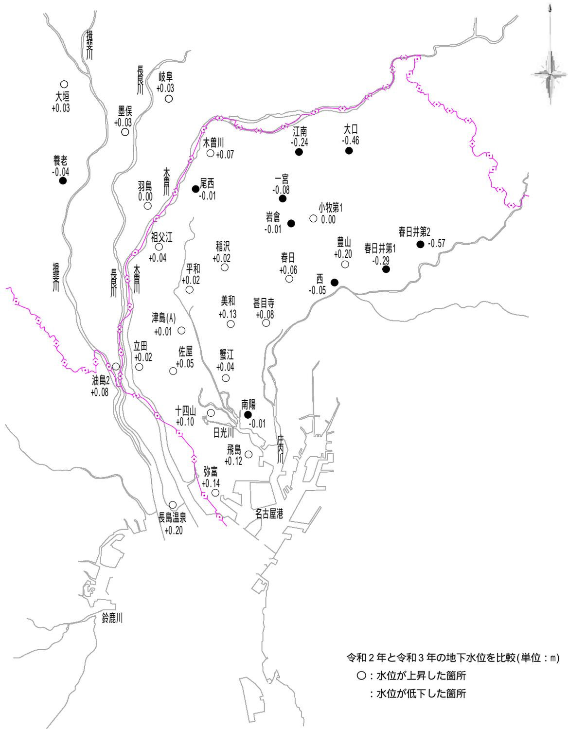
図 - 11(3) 年平均地下水位の変動量[第三礫層(G3)]
