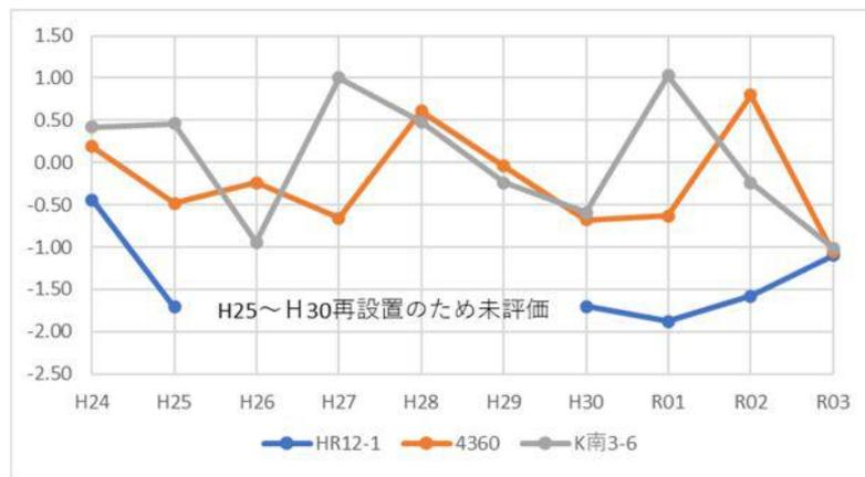
図-1 令和3年における年間沈下量1cm以上の水準点の直近10年年間沈下量
