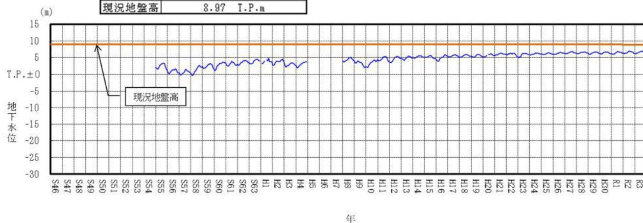
付図 - 2(19) 地下水位変動 (小牧第一)
