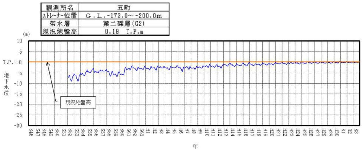
付図 - 2(9) 地下水位変動 (五町)
