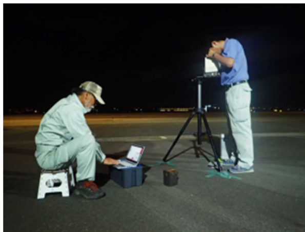
重力の鉛直勾配を測定している風景
