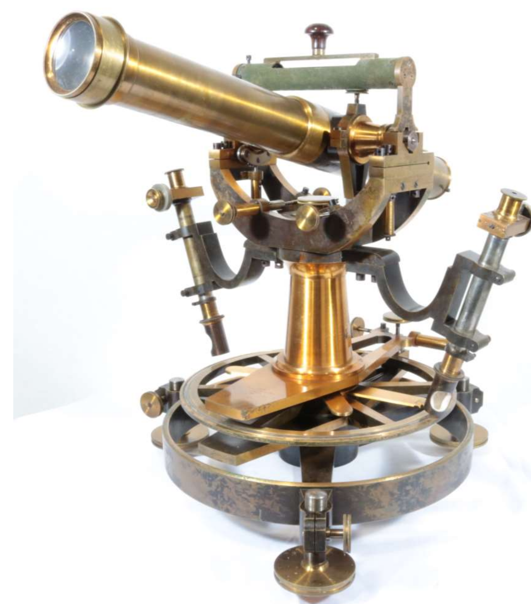
一等経緯儀（ドイツ・カールバンベルヒ社製） 明治期から昭和期まで一等三角測量で多く使用されました。
