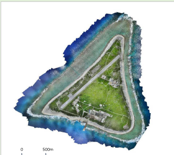
SfM/MVS※処理による オルソ画像作成
