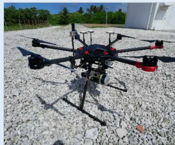
回転翼UAVによる レーザ測量
