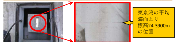
零位を示す水晶板 （日本水準原点）
