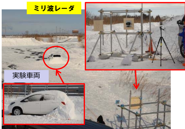
ミリ波レーダによる探知実験の状況
