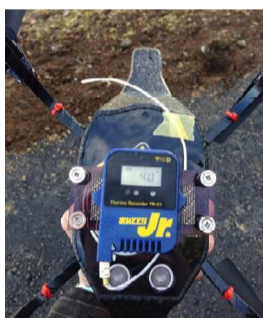
UAVに取り付けた気温計
