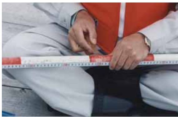
写真11、12 測棹作業(測棹は測量用ポールに鋼尺を貼り付けて使用した)
