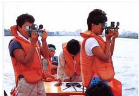
写真-3 六分儀による測位作業(1985年頃)
