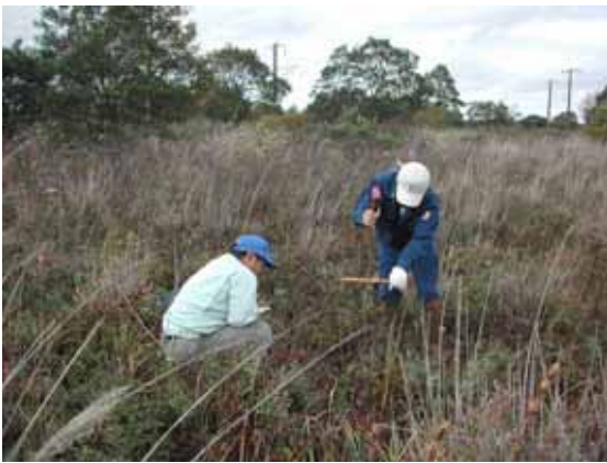
写真 - 7 ボーリングステッキによる試料採取
