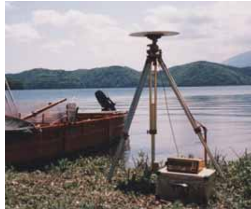
写真-1 GPSを用いた湖沼基準点測量
