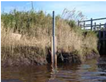
写真-5 パンケ沼に設置した 水位観測所
