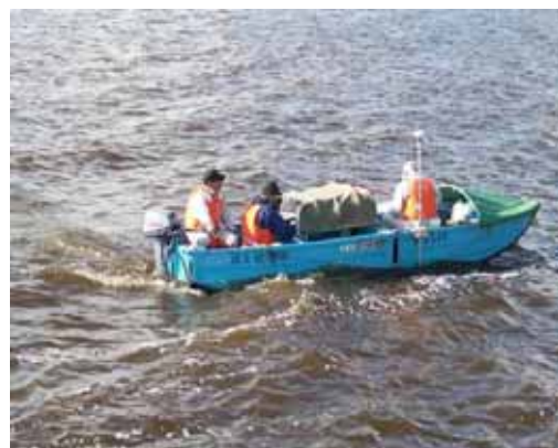
写真-8 音響測深機を用いた測深調査
