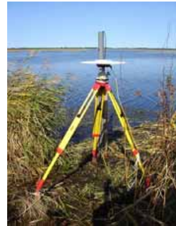
写真 - 4 ベンチマーク設置のためのGPS測量(パンケ沼)
