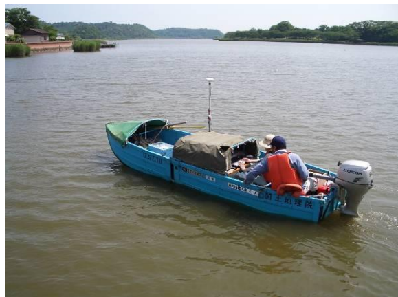
写真－4 音響測深機を用いた測深調査
