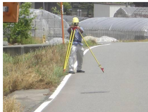
写真－3 北潟湖のベンチマーク高の水準測量
