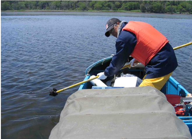
写真 - 8 底質調査(槍式採泥器による)
