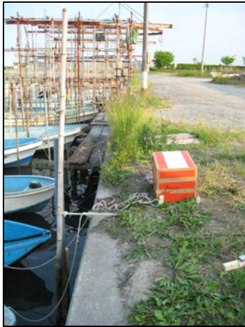
写真6 簡易水位観測所設置状況
