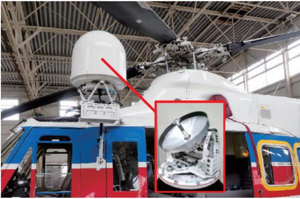
写真-1 はるかぜ号に搭載される可動アンテナとローター基部の位置関係
