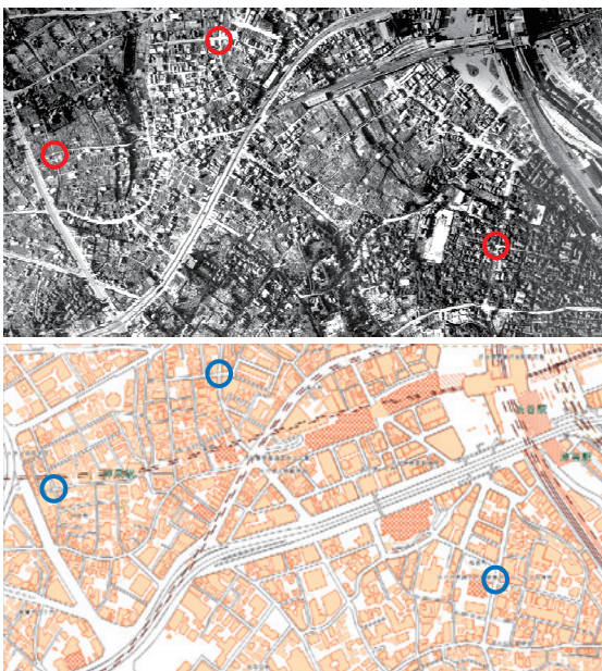
図-13 参照点選定の例（○が対応する参照点） （渋谷駅道玄坂付近） 米軍写真（上） 地理院地図(標準地図)（下）
