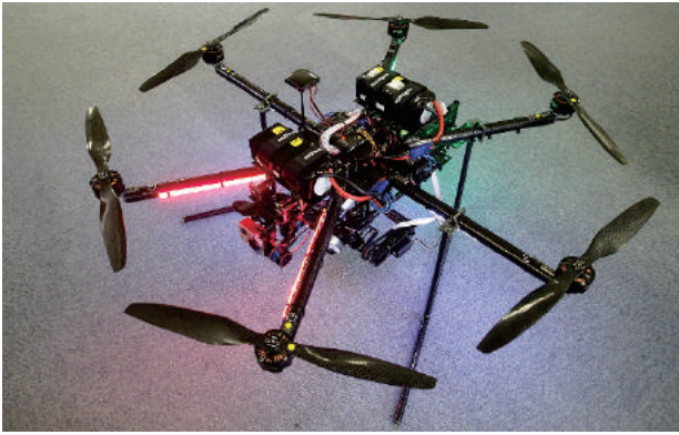
写真-1 撮影に使用した UAV (エンルート社製 ZionPro800)
