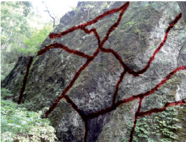
写真-1 地すべり移動岩塊のジグソークラック 分かりやすいようにクラックに着色
