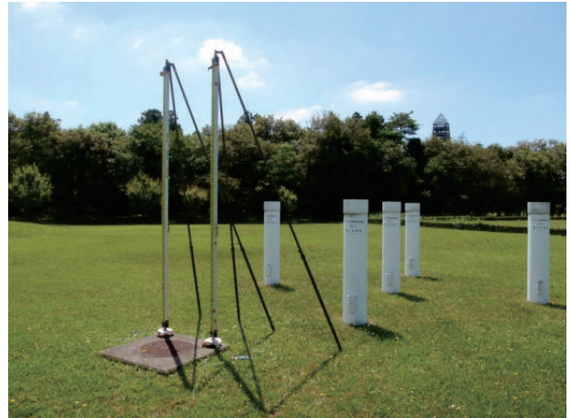
写真-3 水準測量用標尺の設置状況
