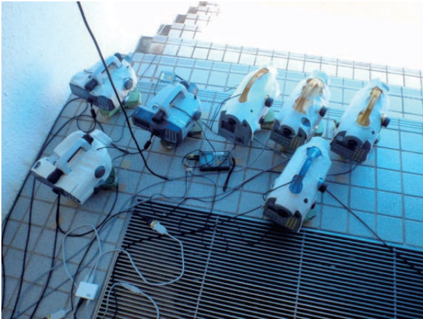
写真-2 電子レベルの設置状況
