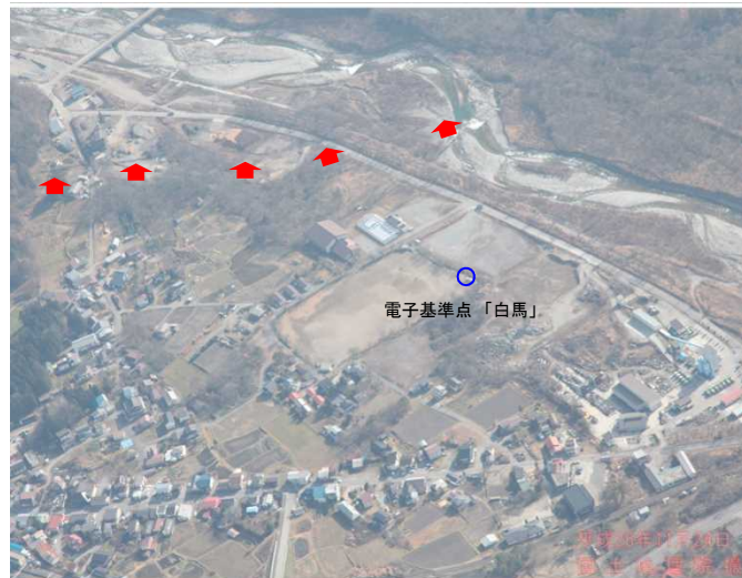
撮影した斜め写真(上部に断層、下部に電子基準点「白馬」)
