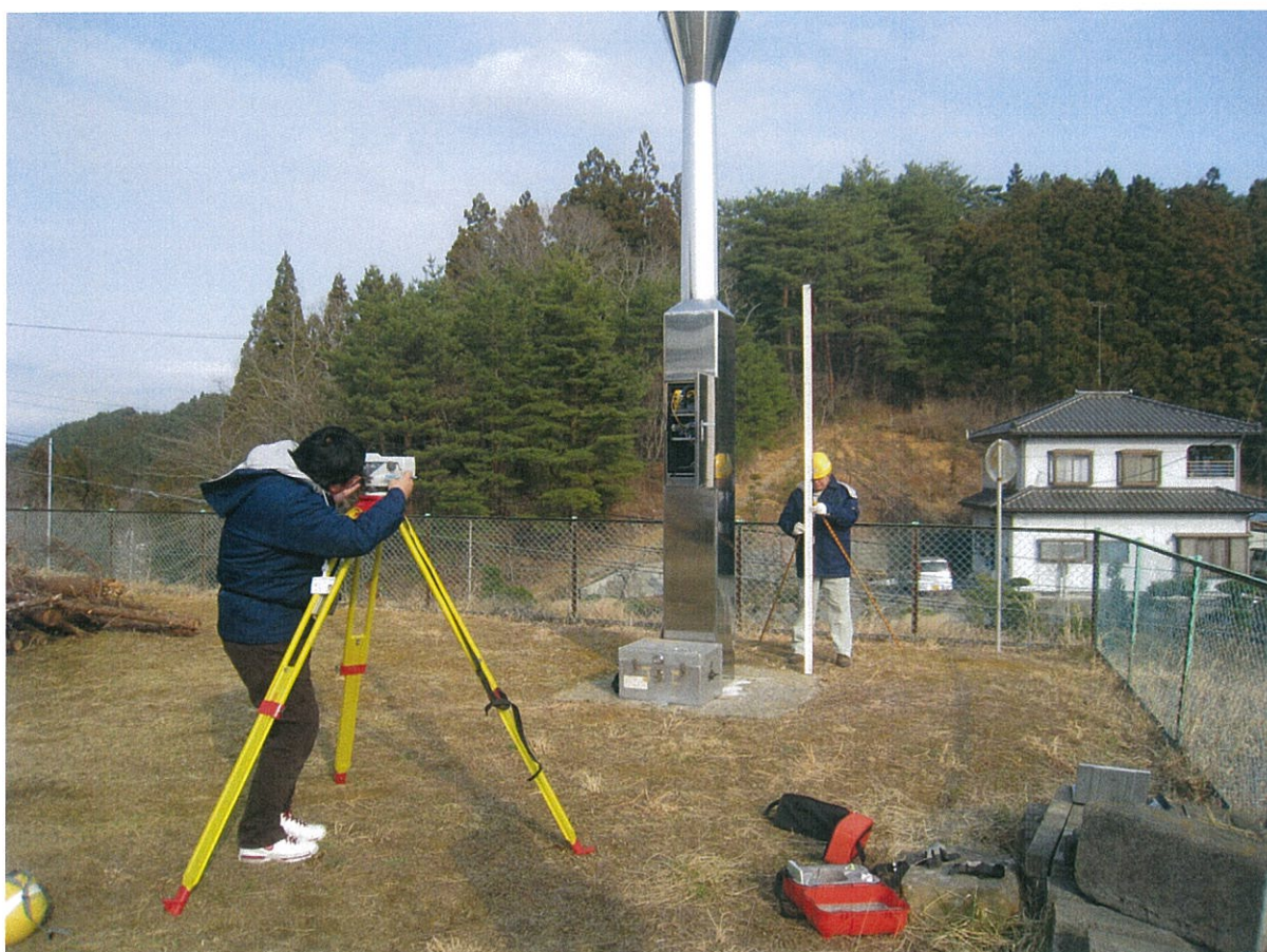
電子基準点「志津川」(宮城県南三陸町)の傾斜測定 3月30日
