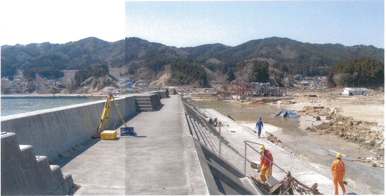
写真: 四等三角点「浦の浜」(岩手県下閉伊郡山田町)でのGPS測量 4月5日 観測の結果53cmの沈下が認められた
