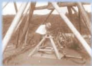
25mインバール基線尺による基線測量
