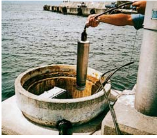
写真-5 水圧式験潮儀センサー部（初島）
