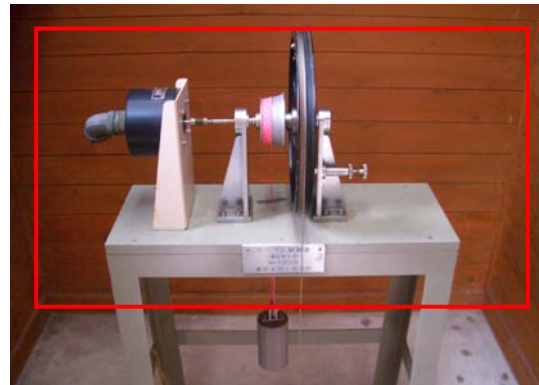
写真－10 油壺験潮場の旧施設にあった験潮儀（機器上部の取り外しを実施）
