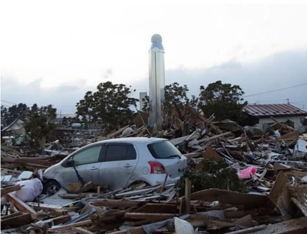
写真－3 津波により被災した電子基準点「名取」
