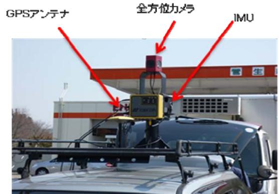
写真－6 車載型画像計測システム (MMS)
