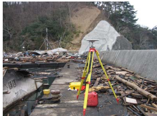
写真-5 大船渡検潮所標高取り付け観測（GPS）
