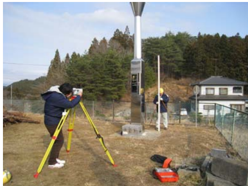
写真-2 電子基準点 950175（志津川）傾斜測定
