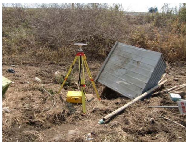
写真-7 地盤沈下調査の観測 (一等水準点 5667)
