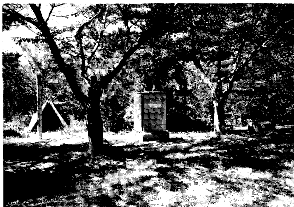
写真-1 地球電磁気連続観測装置の全景(横浜測点) 左側のテント内に磁気点標石が設置されている
