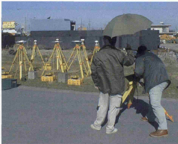
写真-2 GPSアンテナ定数の検定状況
