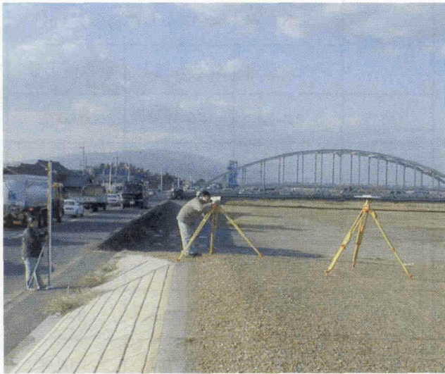
写真-1 GPSアンテナ定数の検定状況
