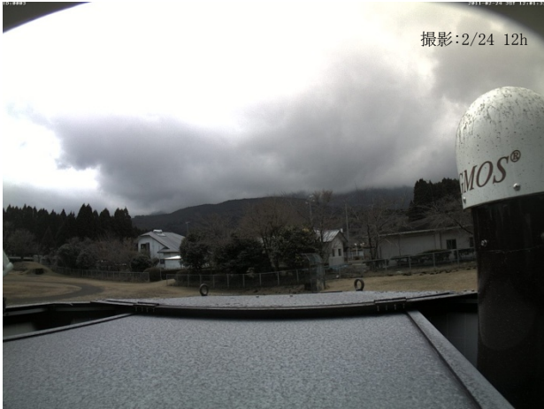
写真-6 ネットワークカメラにより取得した火山灰が付着した REGMOS の状況
