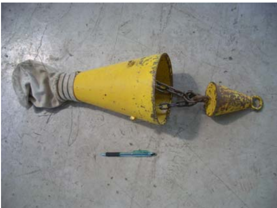
写真-9 ドレッジャー
