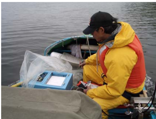
写真-7 測深調査の様子
