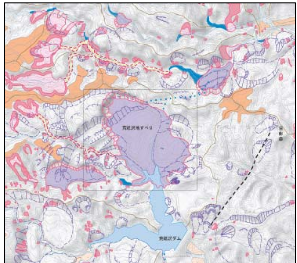
図-8 荒砥沢地すべり（詳細活断層図） （紫のケバと地震前の地すべり、赤のケバ及び紫の色が地震後の地すべり。赤とピンク色が地震後の崩壊、黄色が土石流流送部）
