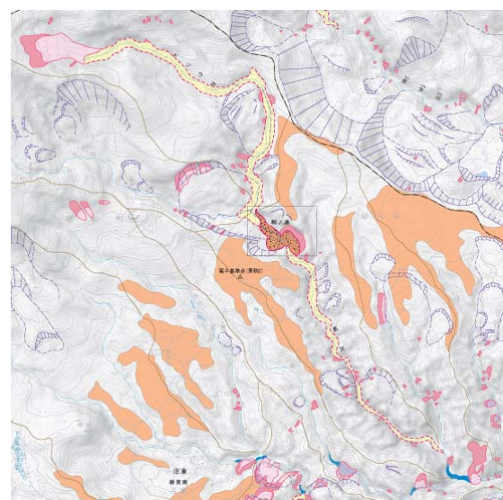
図－10 ドゾウ沢の土石流（詳細活断層図） 黄色が土石流による土砂の流送部
