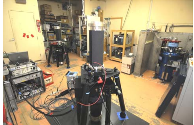
写真-2 昭和基地重力計室内の測定風景 (JARE-51 池田隊員撮影)。左奥が予備点上で測定中の FG5 (#104)、中央が昭和基地 FGS 上で測定中の FG5 (#203)、右の青色の機器は JARE-51 で設置された最新の超伝導重力計 (CT#058)。
