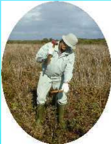
簡易ボーリング調査
