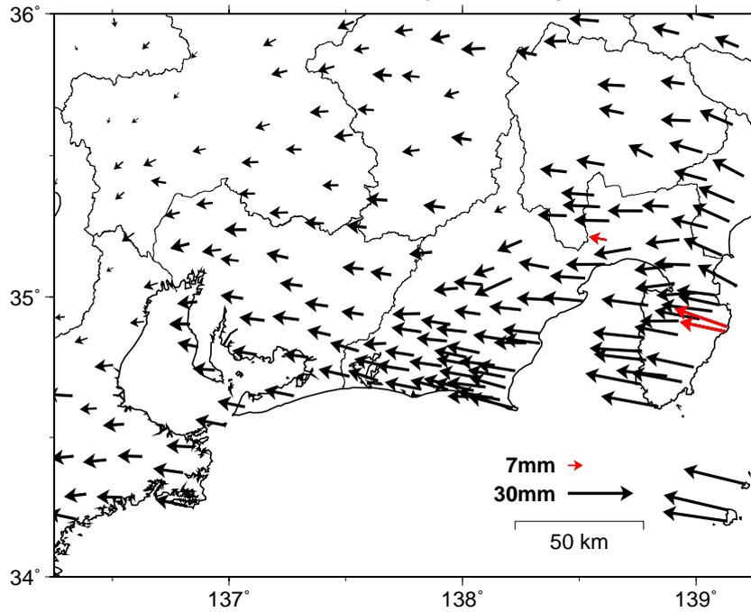
・スロースリップ終息後の変動速度ベクトル（右下図）との差の絶対値が7 mm 以上の変動ベクトルを赤矢印で表示している。
