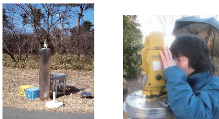
写真-2 コロケーション用ピラー
