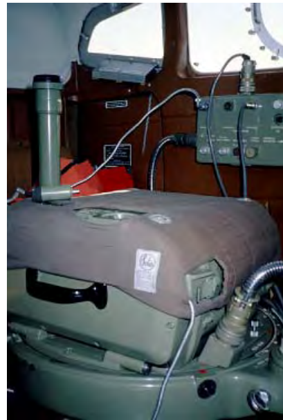
写真-28 セスナ機に設置された航空カメラ RC-9
