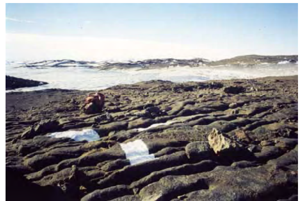
写真-27 白ペンキで塗られた3枚羽根の対空標識
