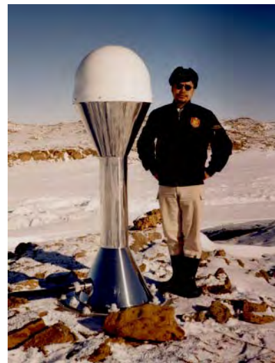
写真-19 アンテナピラーと周辺観測施設
